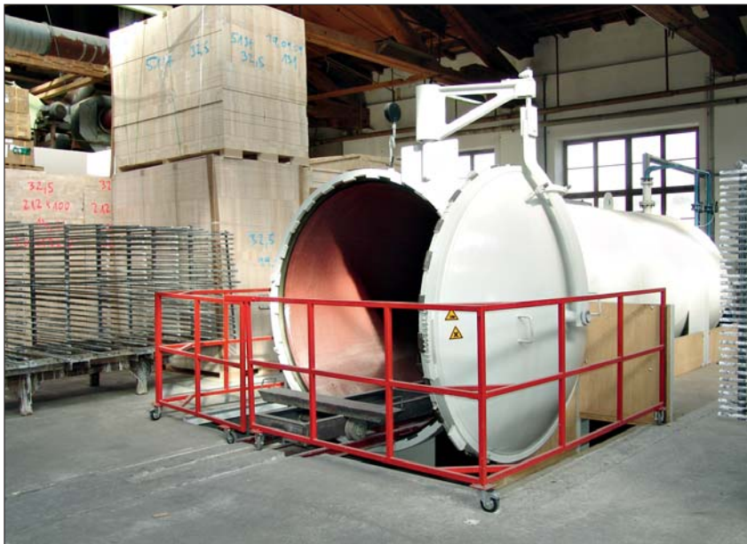
Der neue Vakuum-Imprägnierkessel imprägniert Mittellagen für schwer entflammbare Trägerplatten.
