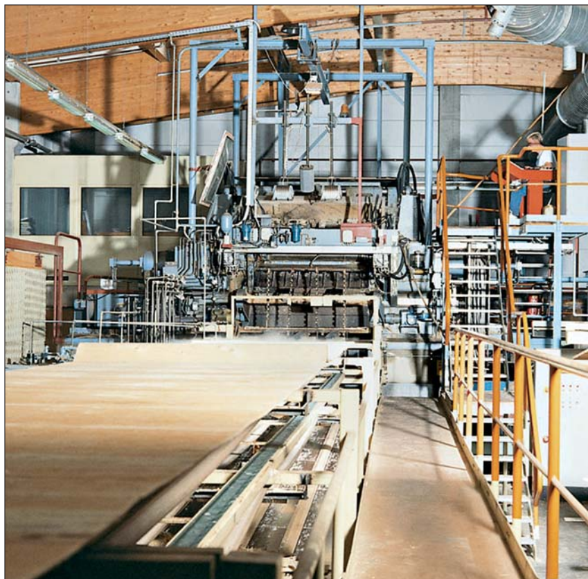
Die Schälmaschine produziert aus konditionierten Fichtenstämmen ein endloses Furnierband in 4 mm Dicke. Ein Rotationsclipper kappt das Furnier anschließend in Standardformate. Fotos: Moralt (2), Schmidt (6)
