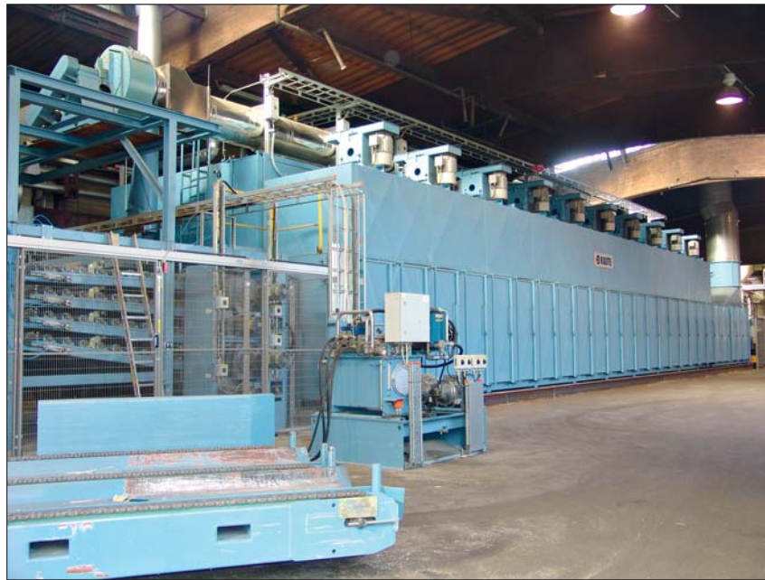
Der neue Vier-Etagen-Rollenbahntrockner von Raute kann im Laufe einer Schicht etwa 40 m 3 Schäl furnierblätter trocknen. Durch den modularen Aufbau ist eine Kapazitätserhöhung in der Zukunft leicht möglich.
