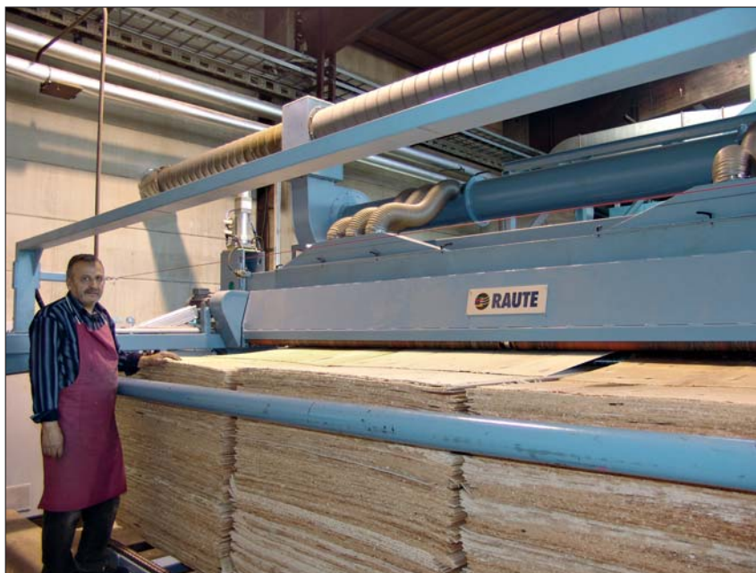
Die Furnierblätter werden in Fixmaßen dem Trockner stapelweise zugeführt. Das Einlegen der Furnierblätter in den Trockner erfolgt automatisch per Vakuum. Ein Maschinenführer überwacht den gesamten Trocknungsprozess.
