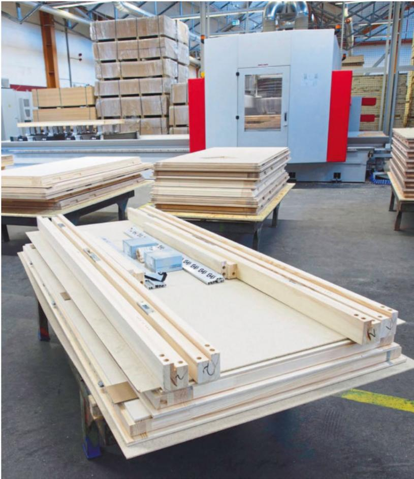
*/ Zusammenbauen, Oberflächenbehandlung, Beschläge montieren – fertig: Ein CNC-Bausatz, hier mit einflügeliger Tür inkl. Doppelfalzdichtung, Baka-Bändern, Dreifallenschloss und Schwelle.*
