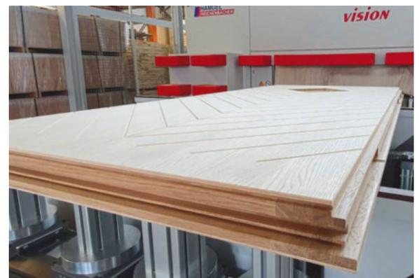
*/ Auf der CNC-Maschine werden pro Tag im Pendelbetrieb rund 30 individuelle Türen hochpräzise in Stückzahl 1 bearbeitet.*
