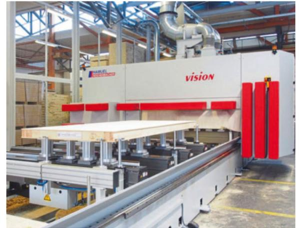
*/ Das 5-Achs-CNC-Bearbeitungszentrum Vision-III-T-5 von Reichenbacher ermöglicht Moralt eine noch größere Vielfalt und Flexibilität.*
