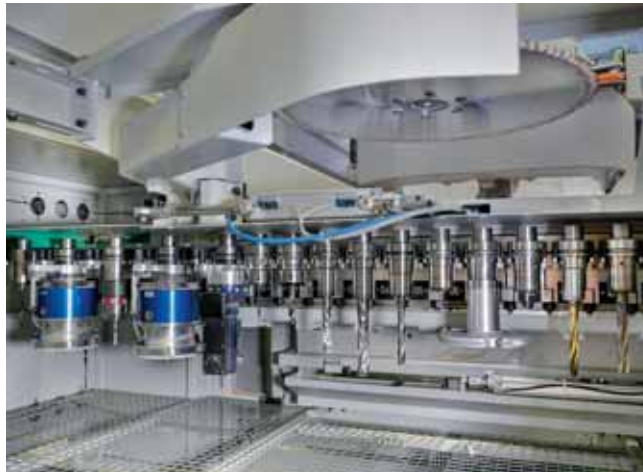
Der automatische Kettenwechsler für 61 Werkzeuge ist innerhalb der Portal-Kapselung hinter dem Arbeitsaggregat angebracht
