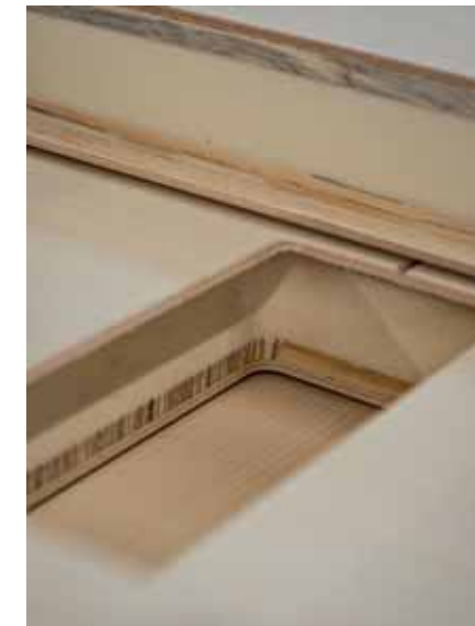
20 Prozent der Haustürrohlinge werden inzwischen komplett bearbeitet. Auch Lichtausschnitte mit angefrästen Glasleisten oder ausgestochenen Ecken sind möglich
