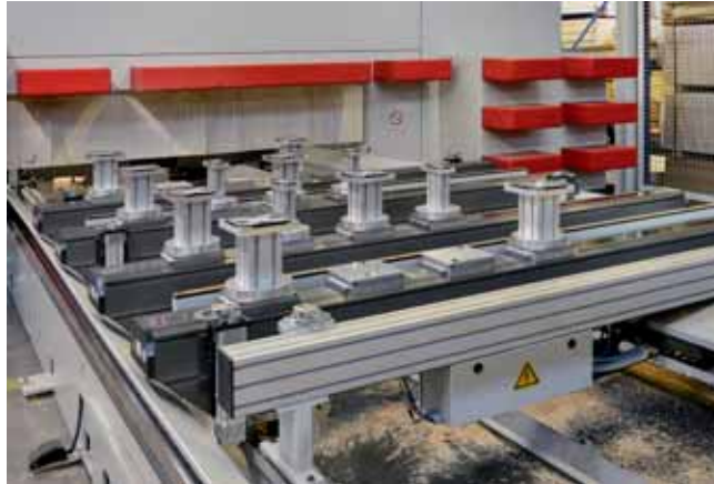
An den acht Tischträgern können Pneumatikspanner, Anschläge und Unterstützungsschienen befestigt werden
