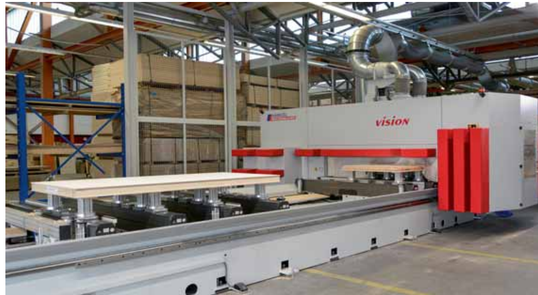
Die Hochleistungsanlage „Vision III-T“ mit automatischem Trägertisch hat Tischmaße von 7.000 x 2.080 mm
